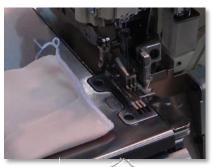
針落ちから空環をカットするメス位置まで®が 20 mmと短く 短い縫製工程にも対応しています。
