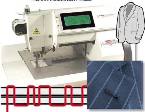
“本物のハンドステッチ”を創り出す AMF Reece 社の独自機構により、テーラーの手縫いの場合と全く同じように、1針毎に糸が素材を貫通してステッチを形成します。競合他機種では、単一の針棒でフック針を使用しますが、針が生地に深く貫通するため、薄物地やデリケートな素材の場合にはキズが発生する可能性があります。しかし、この Deco 2000 なら、フローティング・ニードル方式による本格的な唯一のハンドステッチマシンであり、広範囲な素材に安定した高品質をお約束いたします。
