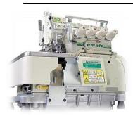
自動バックタック装置により、オペレーターは空環 切り付きオーバーロック同様の作業をするだけで、 素早く確実に縫い初めの空環始末が可能です。
